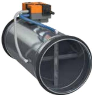
Le KOS-C est un clapet de réglage de débit d'air pour le contrôle du débit volumétrique variable (VAV) dans les systèmes de conduits. Il se compose d'un registre, d'une unité de mesure et d'un régulateur. Le contrôleur est équipé d'un capteur de pression différentielle pour mesurer le débit volumétrique.
